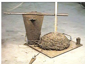
Consistenza S4 slump 160 - 210 mm
