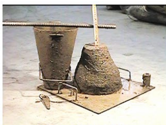
Consistenza S2 slump 50 - 90 mm
