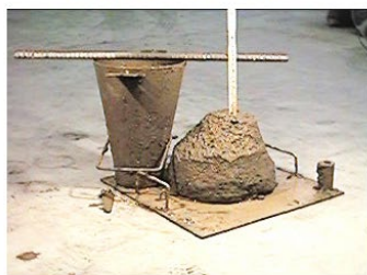
Consistenza S3 slump 100 - 150 mm
