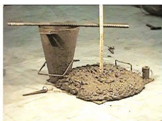
Consistenza S5 slump > 220 mm
