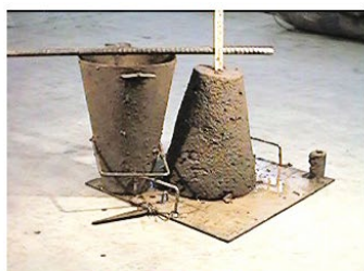
Consistenza S1 slump 10 - 40 mm
